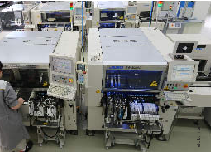
Vier Linien zur automatisierten Beestückung finden sich in der SMT-Fertigung von Hannusch.
